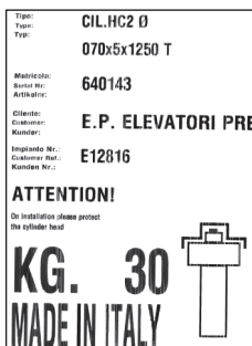
Fig. 3 – Matricola e targa di identificazione del cilindro
